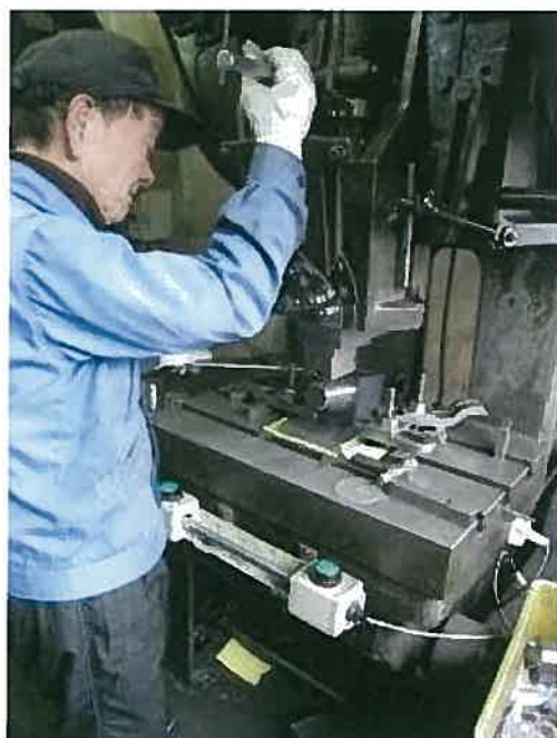
⑦治具にタンブラーを設置したら、加工する位置、深さを手作業でプレス加工機を調整していく。
