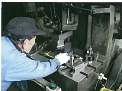
⑦-3:上部、下部の金型をプレス加工するまでの調整が非常に難しく職人の腕の見せ所である。
