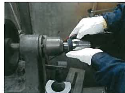
③仕上げに回転機械に装着して手作業で表面を仕上げて完成。
