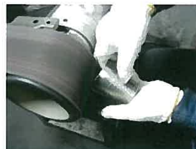
①-2:溶接部研磨加工。エンドレスに#180のスコッチを装着して研磨。
