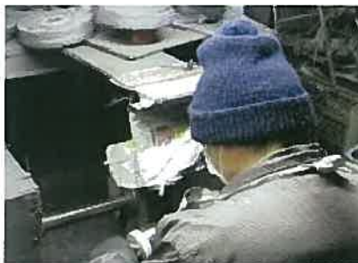
②表面にヘアライン加工を施し、製品の質感を高める。1つ1つ手作業で行い製品に燕魂を注入。
