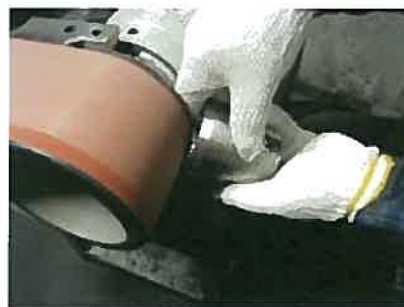
①-1:溶接部研磨加工。エンドレスに#120の研磨ベルトを装着して研磨。
