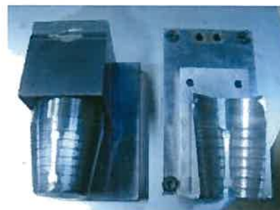
⑦-2:上部金型(右写真) 下部金型(左写真)
